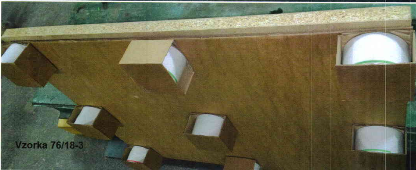
Obrázok č. 5: Vzorky paliet po skúške
